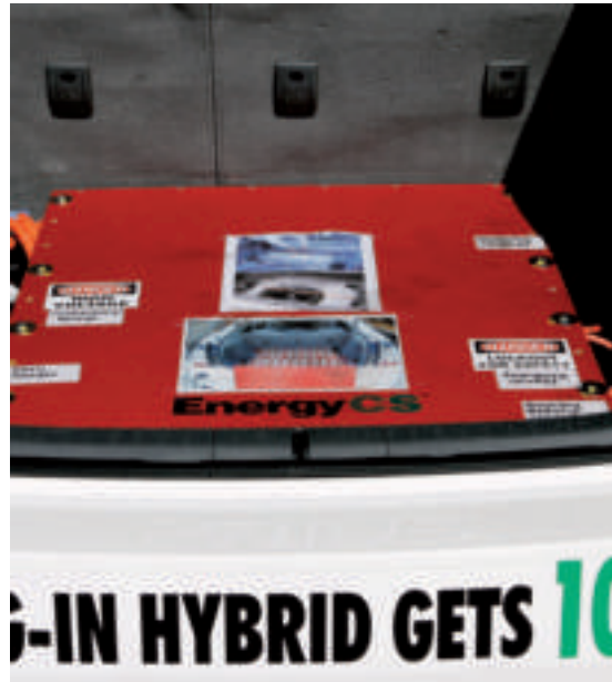
Über Monitor sieht man den Ladezustand der Batterien (links). Eingebaut sind sie im Kofferraum.
