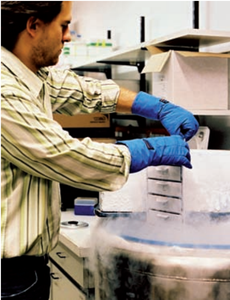
Links: Boris Greber bei der Entnahme von eingefrorenen Zellen aus einem Flüssigstickstofftank. Rechts: Roboter aus der Hochdurchsatzabteilung.
